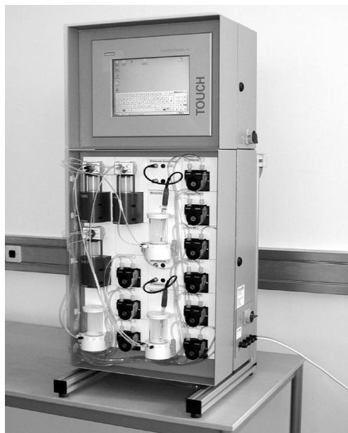
Abb. 3: Beim online System kann der Steuer-PC direkt auf das online Gerät montiert sein oder je nach Bedarf auch mehrere 100 Meter davon entfernt positioniert werden
