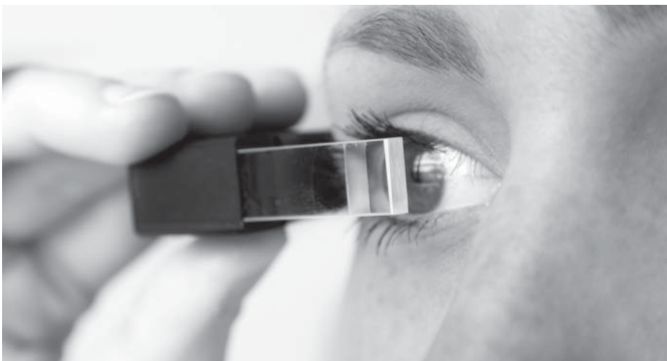
Das near-to-eye Display mit Durchsichtsfunktionalität ermöglicht einen kleinen, unauffälligen Aufbau. (© Fraunhofer IOF) | Bild in Farbe und Druckqualität: www.fraunhofer.de/presse
