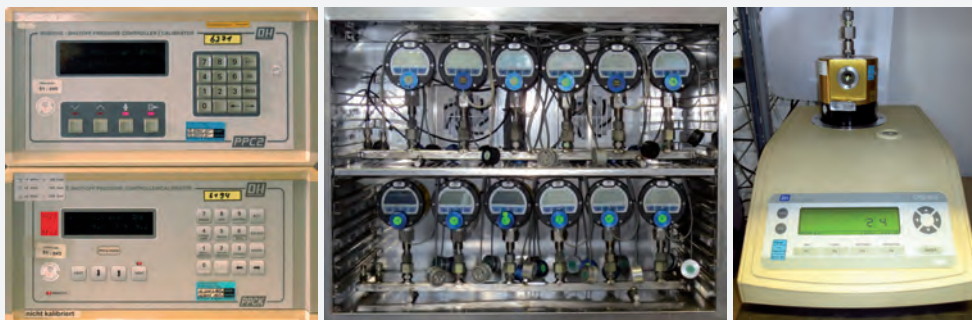
Bild 11: Kalibrierstand für Sensoren (Komponenten)
