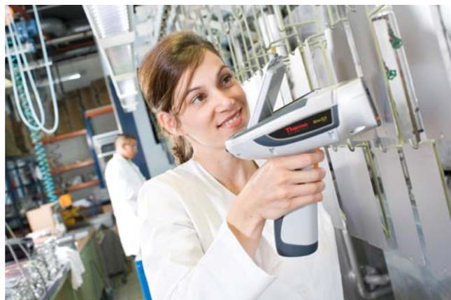
**BiU:** Gleichbleibend beste Qualität – dank Schichtdickenmessungen mit dem mobilen RFA-Spektrometer Niton XL3 Air direkt an der Beschichtungsanlage.
