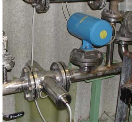
Schallsensor in einem Polymerisations – Reaktor    Schallsensor und Refraktometer in einer Rohrleitung
