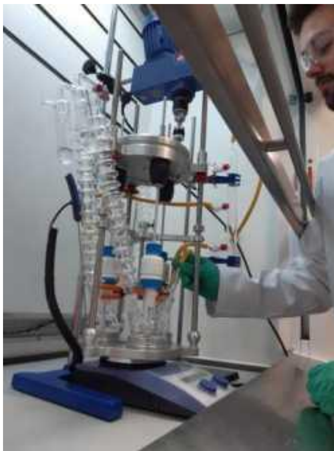
Bildunterschrift: DrySyn Vortex Rührwerk mit Heizplatte bei der Durchführung von 3 Parallelreaktionen
