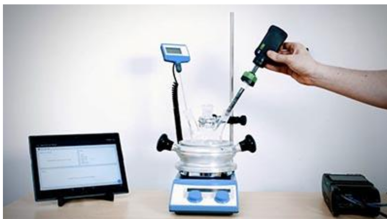
Bild: Deepmatter® SmartChemistry-Technologie® in Verbindung mit der ölfreien Heizplattform DrySyn und dem Asynt-Kochplatten-Kit.
