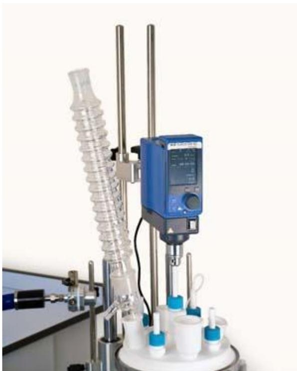
Bilder: Sichere und nachhaltige Refluxreaktionen im großen Maßstab mit einem CondenSyn MAXI
