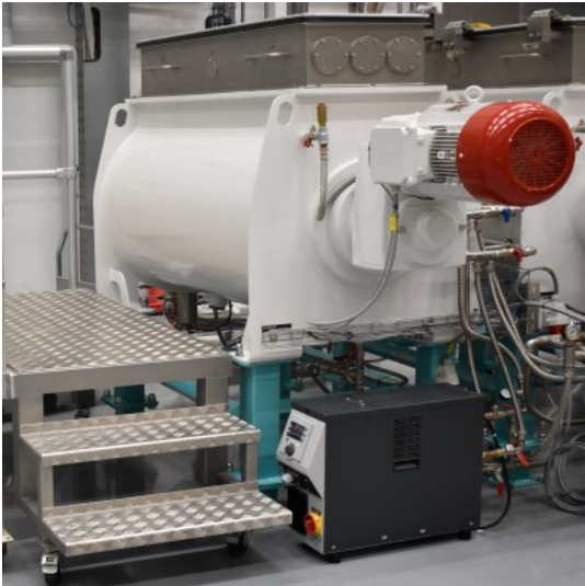
Abbildung 1: Dosierer-Mischer-Kneter-Conchierer, Durchsatz 400 kg/h, temperiert bis 90°C
