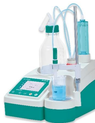
Der Eco Titrator von Metrohm: erhältlich mit komplettem Zubehör für die Bestimmung des FOS/TAC-Werts
