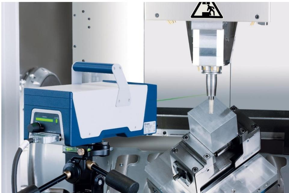
Bild2: Direkte Messung auf rotierenden Teilen – QTec in seinem Element
